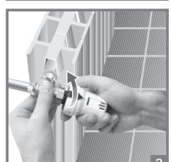
3) Ruotare la ghiera di limitazione e bloccaggio in senso orario fino a giungere a fine corsa mantenendo ferma la manopola.
