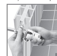
3) Ruotare la ghiera di limitazione e bloccaggio in senso antiorario fino a fine corsa, tenendo fermo la manopola.
