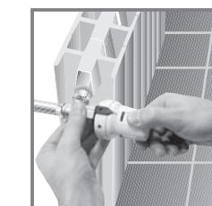
1) Ruotare la manopola del comando termostatico sul valore prescelto
